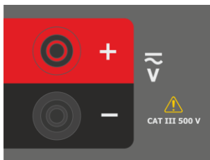
Tomas de entrada de voltaje
